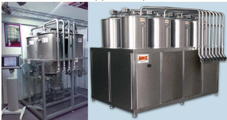
Автоматическое управление микро-ингредиентов обеспечивает последовательное дозирование продуктов, исключая сокращение отходов. Кроме того, она позволяет содержать помещения в чистоте и порядке в соответствии с законодательством, положениями и правилами санитарии и гигиены.
